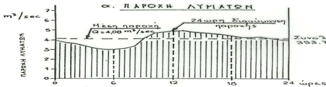
Εικ. 2.13 ΧΑΡΑΚΤΗΡΙΣΤΙΚΑ ΤΩΝ ΛΥΜΑΤΩΝ ΤΩΝ ΑΘΗΝΩΝ ΣΤΟΝ ΚΕΝΤΡΙΚΟ ΑΠΟΧΕΤΕΥΤΙΚΟ ΑΓΩΓΟ (ΕΝΔΕΙΚΤΙΚΑ ΣΤΟΙΧΕΙΑ ΜΕΤΡΗΣΕΩΝ 1975)
